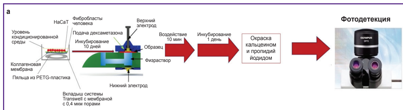
Рис. 3. Тестирование пассивной и активной диффузии дексаметазона через модели мембраны круглого окна (мМКО):
